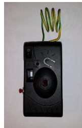
Abbildung 6: RFID Zapper, gebaut aus einer Kamera [17]
