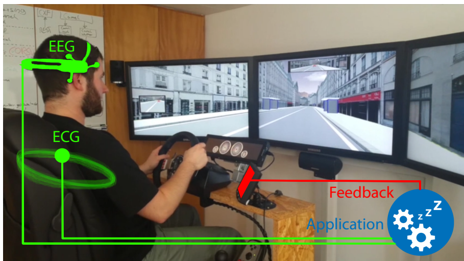
Abbildung 1: Skizze des Systemaufbaus: Körpersensoren (Elektroenzephalografie / Elektrokardiogramm) liefert Daten an die Applikation und ein Feedback-Device warnt den müden Fahrer. Bild zeigt den Fahrersimulator der Reutlingen University.
