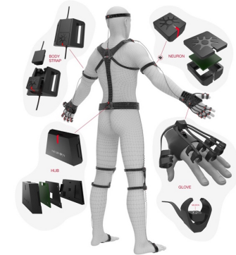
Abbildung 2: Perception Neuron, ein auf Microcontrollern und Sensoren basierendes Mocap-System 2
