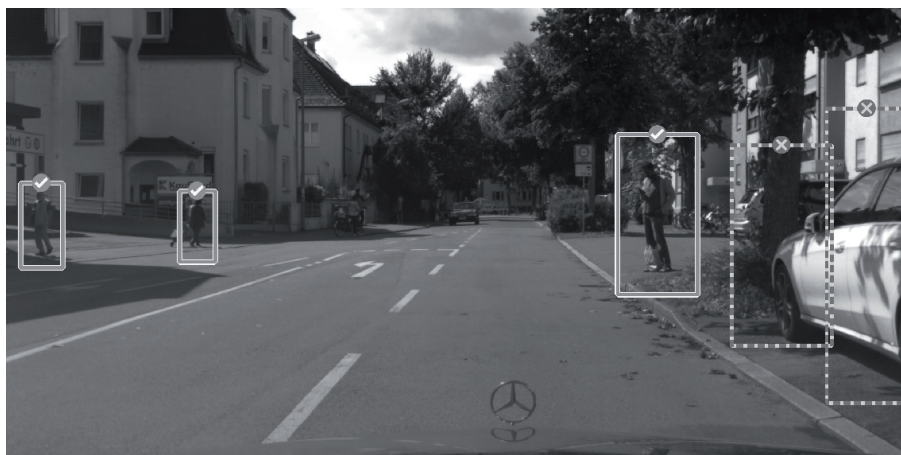
Abbildung 2: Beispiel eines Bildes aus dem Labeling Tool mit Vorschlägen eines Vorklassifikators für die Erkennung von Fußgängern. Die ursprüngliche Bildaufnahme stammt aus dem Cityscapes Datensatz (vgl. [5]) und wurde vom Labeling Tool mit BB versehen.
