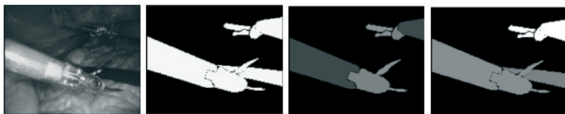
Abbildung 3: Ausschnitt aus dem Datensatz (von links: Originalbild, Binäre Segmentierung, Multiklassensegmentierung: Instrumententeile, Multiklassensegmentierung: Instrumentenart) nach [11]
